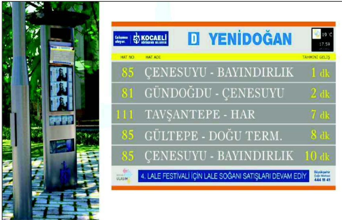
Şekil 3.2. Akıllı Durak Yolcu Bilgilendirme Sistemi (Kocaeli)
